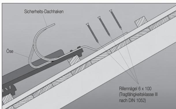
**Sicherheits-Dachhaken nach DIN EN 517 Typ A dürfen nur auf Dachkonstruktionen befestigt werden, die den Anforderungen der DIN 1052 Holzbauwerke entsprechen.**
