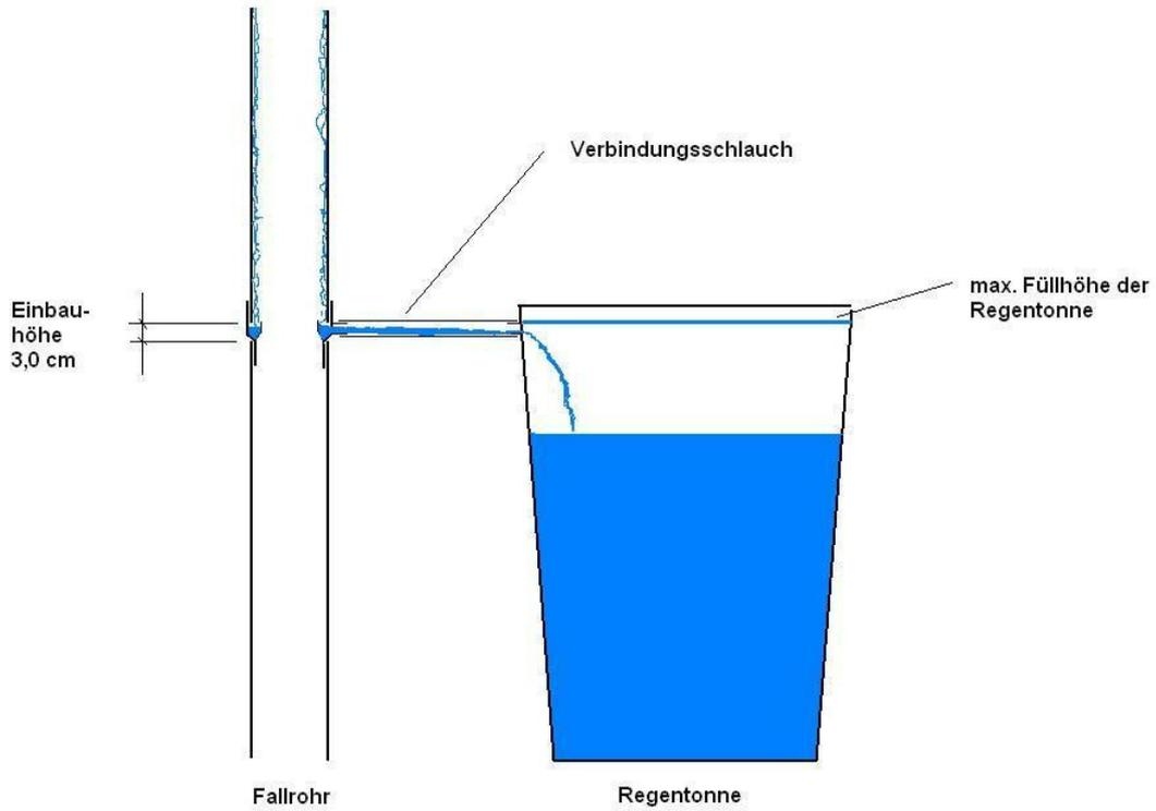
Tipp: Wenn der Verbindungsschlauch mit leichtem Gefälle (2- 3cm) verlegt wird kann das Regenwasser schneller abfließen d. h. es kann bei starkem Regen mehr Wasser gesammelt werden. Beachten Sie dabei jedoch das die Oberkante der Regentonne nicht tiefer ist als der Schlauchanschluss des Regensammlers, da die Tonne sonst überläuft.
