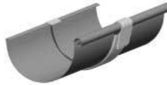
Sicherungsklammer aufbiegen, Wulstklammer über Wulst legen und nach unten einschnappen lassen, Sicherungsklammer zubiegen.
