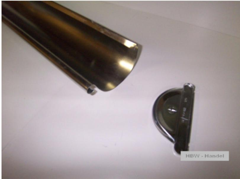
**Schritt 1:** bördeln Sie ca. 5 mm am Ende der Dachrinne leicht schräg nach unten
