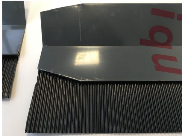
Am überlappenden Blech muss an der Rückseite die Schürze entfernt werden, die Falze müssen mit einem Schraubenzieher leicht aufgebogen werden.
